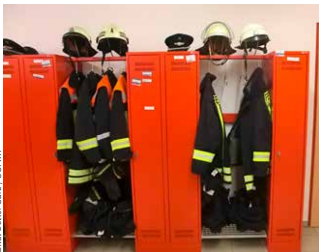
Bild 5: Spinde mit der Möglichkeit zur Schwarz-Weiß-Trennung durch Ablegen der PSA im offenen Teil und der privaten Sachen im geschlossenen Spindelteil daneben (siehe DGUV Information 205-008 „Sicherheit im Feuerwehrhaus“)
