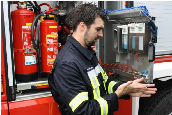
Hygieneboards am Fahrzeug helfen bei der gründlichen Reinigung der Hände direkt vor Ort.
