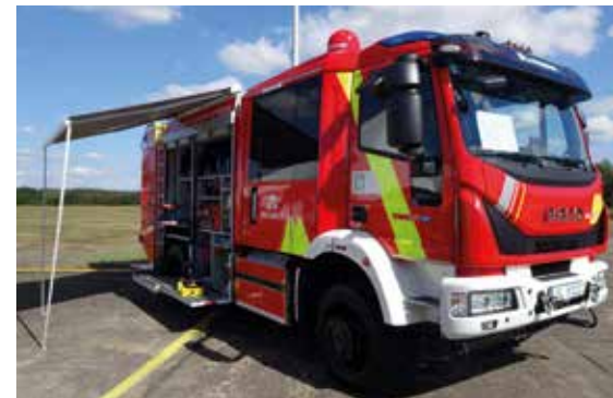
Fahrzeug Vegetationsbrandbekämpfung mit integriertem Sonnenschutz
