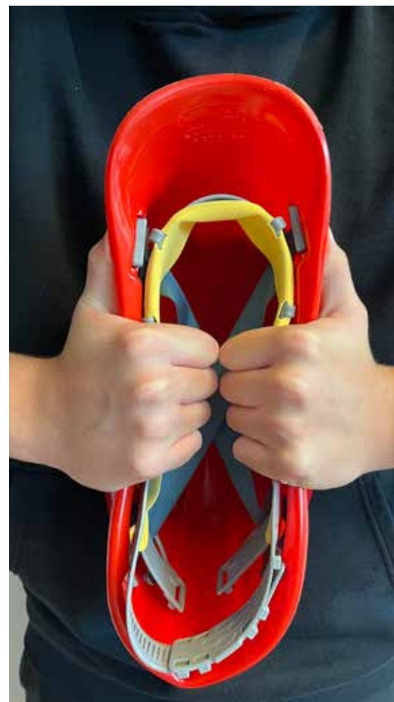
Knacktest zur Überprüfung des Helmes
