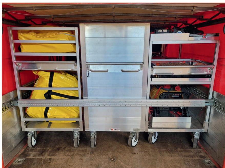
Mit einem Querriegel gesicherte Rollcontainer auf einem Gerätewagen-Logistik
