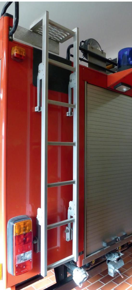
Aufstiegsleiter am Feuerwehrfahrzeug. Scharniere und Halterungen dieser Leitern dürfen bei der Prüfung nicht vergessen werden.
