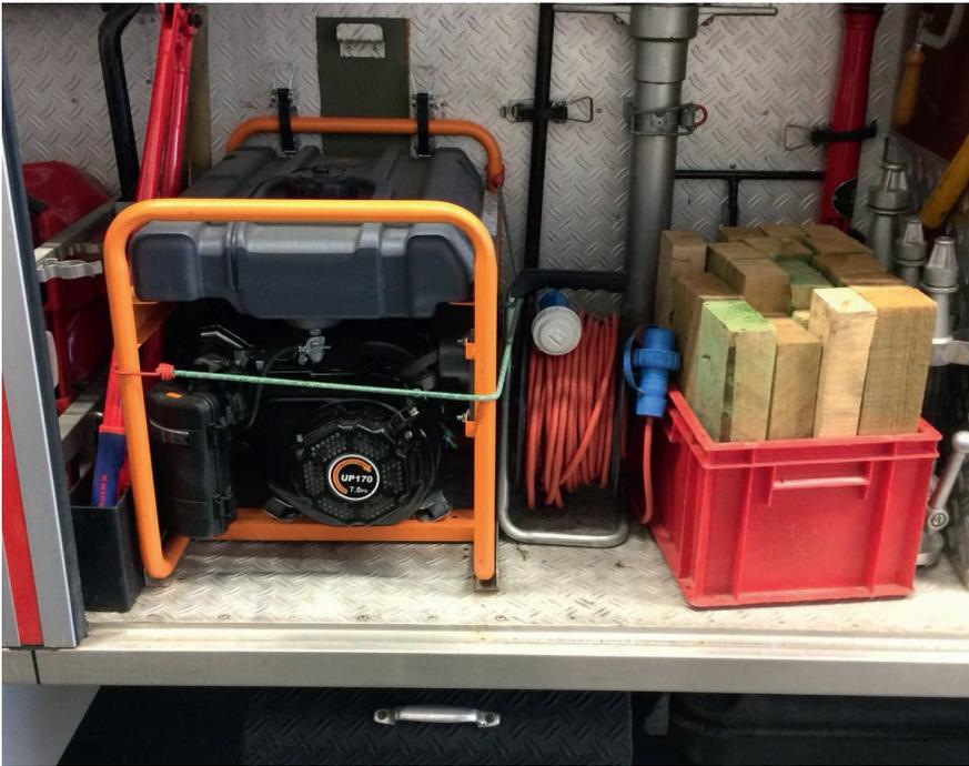
Ungesicherte Gerätschaften und Materialien bei einer Fahrzeugüberprüfung
