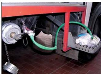
**Reinigen:** Einfache Reinigungseinrichtung für Einsatzstellen.
