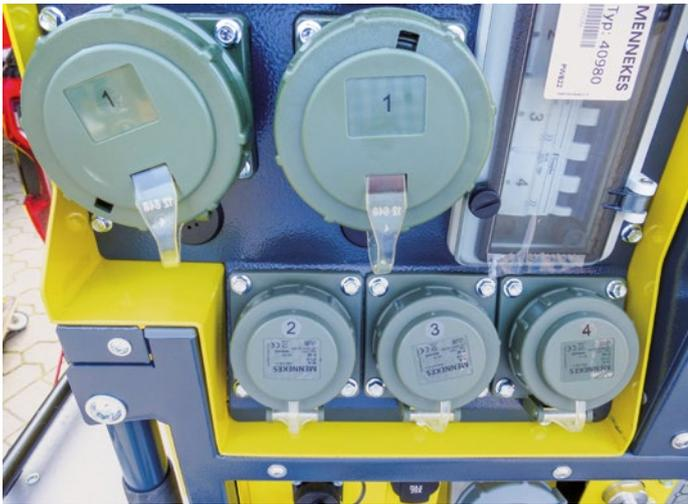
**Abbildung 1:** Steckdosen an einem mobilen Stromerzeuger für die Direktversorgung von Geräten an der Einsatzstelle.
