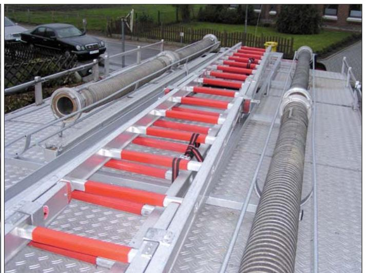
**Verschoben:** Passende Halterung für die Leiter fehlen, so dass diese sich verschieben kann.
