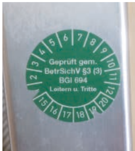
Prüfplakette: Diese Leiter ist ordnungsgemäß geprüft.
