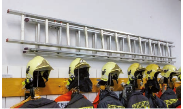
Kritisch: Die Leitern in diesem Feuerwehrhaus sind unzureichend gelagert.
