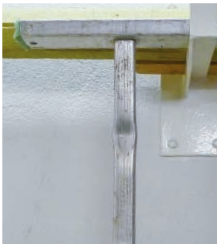
Defekt: Der Knick in einer Leitersprosse kann zur Aussonderung führen.
