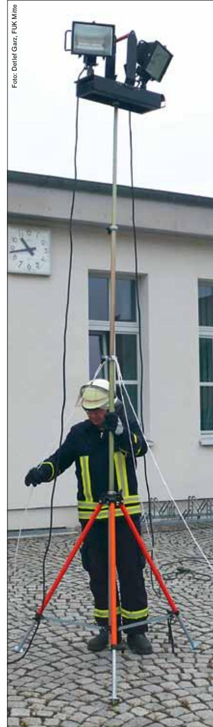
**Achtung:** Das große Stativ (> 3,5 m), hier mit aufgesetztem Halogen-Flutlicht-Leuchtsatz und Abspannung, muss richtig bedient werden.
