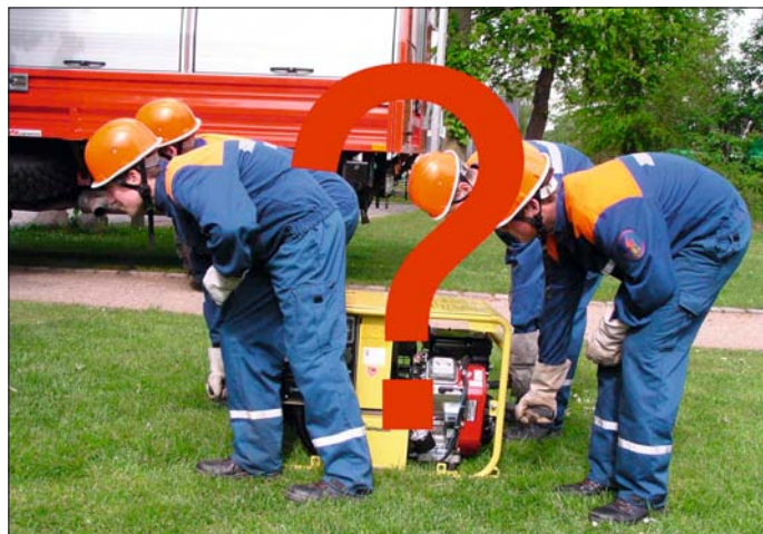
Wie schwer ist ein Stromerzeuger? Ein Stromerzeuger nach Norm wiegt zwischen 100 und 150 kg je nach Ausführung.
