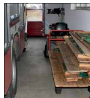
Falsche Lagerung: Klapptische und -bänke engen den Verkehrswege ein.
