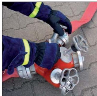
**Niederschraubventile:** Diese Verteiler ermöglichen ein langsames Öffnen, wodurch mögliche Gefahren vermieden werden.
