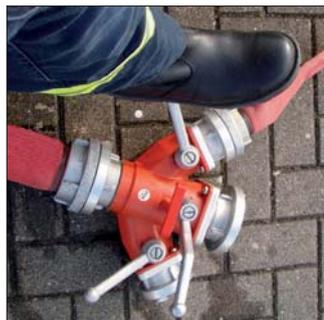
**Kugelhahnverteiler:** Das Öffnen mit dem Fuß führt zu schlagartigen Druckerhöhung – so nicht! schlagartiges Öffnen.
