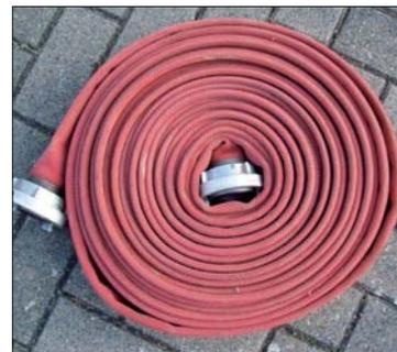
**Einfach gerollt:** Ein einfach gerollter C-Schlauch muss mit größerem Kraftaufwand ausgeworfen werden.
