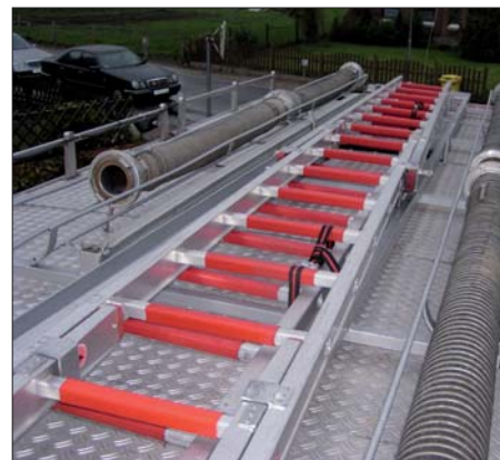
Dach: Unzureichende Halterung einer Leiter auf dem Fahrzeugdach
