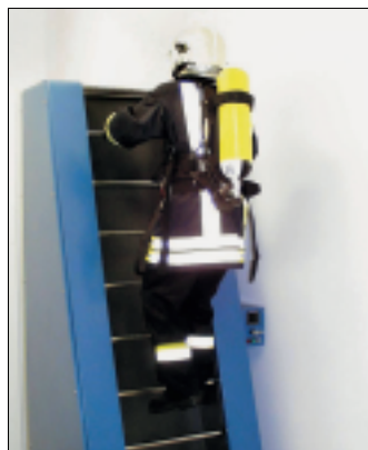
Arbeitsmessgeräte: Endlosleiter, Fahrradergometer und Laufband zum Erbringen der erforderlichen Gesamtarbeitszeit von 80 kJ.
