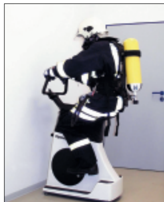
Arbeitsmessgeräte: Endlosleiter, Fahrradergometer und Laufband zum Erbringen der erforderlichen Gesamtarbeitszeit von 80 kJ.
