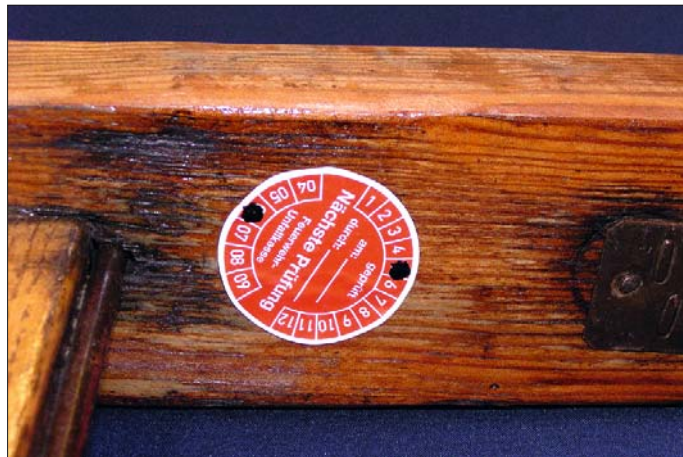
Prüfplakette: Die Prüfplakette an der Leiter vermittelt Sicherheit.
