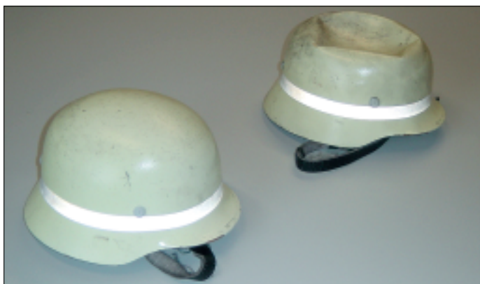
Zu heiß: Die Außenhaut beult sich nach innen, was zu gefährlicher Strangulation führen kann.
