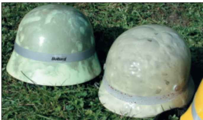
Gefährlich: Bei hohen Temperaturen kommt es bei dem Helm aus Textil-Phenol-Kunstharz zur Blasenbildung.
