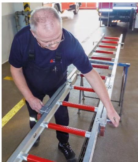
**Durch befähigte Personen:** Regelmäßige Sicht- und Funktionsprüfung der Steckleiter.
