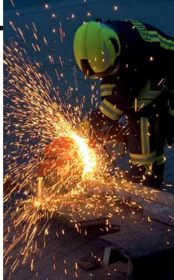
Gefährdungsanalyse: Der Augen- und Gesichtsschutz, hier auch gegen wegfliegende Teile, ist der Einsatzsituation anzupassen.
