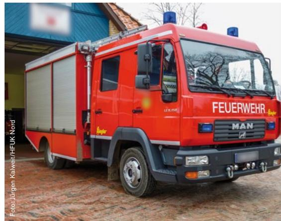
**Überladen:** Bei einem baugleichen Fahrzeug dieses Typs musste von der Aufsichtsperson die Reduzierung der Beladung um 600 kg gefordert werden, damit es mit mehr als zwei Personen genutzt werden darf.
