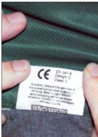
Kennzeichnung 2: Schnittschutz in der Beinbekleidung EN 381-5 Form C.
