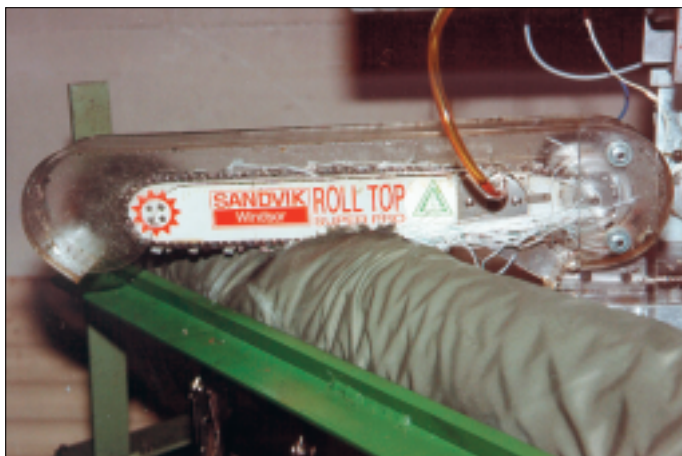
Prüfung: Testen des Schnittschutzes einer Schnittschutzhose.
