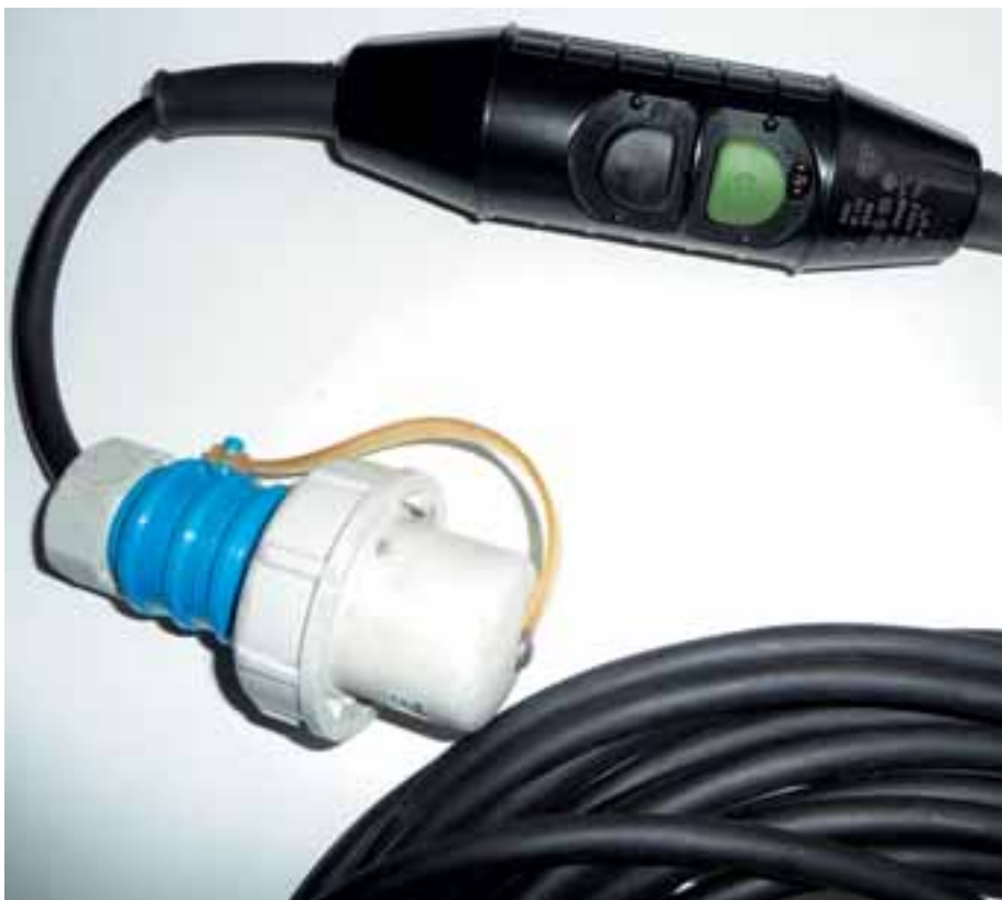
Bei der Benutzung unbekannter Elektroanschlüsse muss ein so genannter Personenschutzschalter verwendet werden.
