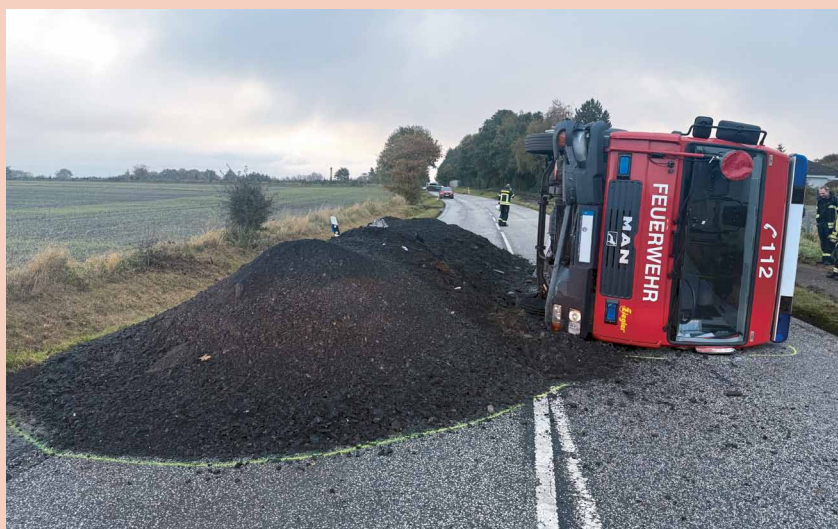
Durch das Auffahren auf einen Haufen abgefrästen Asphalt verunglückte dieses Tragkraftspritzenfahrzeug.
