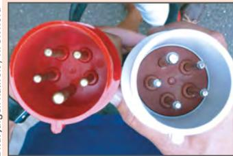
Roter Stecker mit 6 Uhr Stellung und rechts ein grauer Stecker mit 11-Uhr Stellung zur Einspeisung
