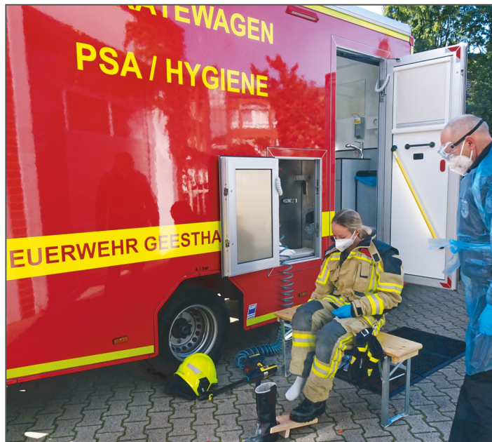
Katharina von Goeckingk von der FF Geesthacht zeigt die Funktionsweise des GW PSA / Hygiene: Eine Grobreinigung und das Ablegen von Helm und Stiefeln erfolgen draußen, danach geht es ins Fahrzeuginnere im Einbahnstraßenprinzip.
