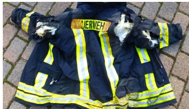
▶▶ Zweck eindeutig erfüllt! Die Feuerwehrjacke des Atemschutzgeräteträgers wurde zwar völlig zerstört, verhinderte jedoch schlimmere Verletzungen.
