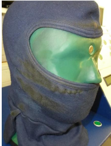
▶▶ An der Flamschutzhaube sind deutliche Spuren von Wärmebeaufschlagung erkennbar.
