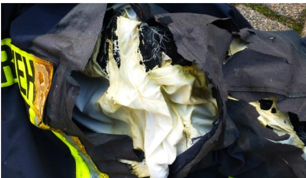
▶▶ Zweck eindeutig erfüllt! Die Feuerwehrjacke des Atemschutzgeräteträgers wurde zwar völlig zerstört, verhinderte jedoch schlimmere Verletzungen.
