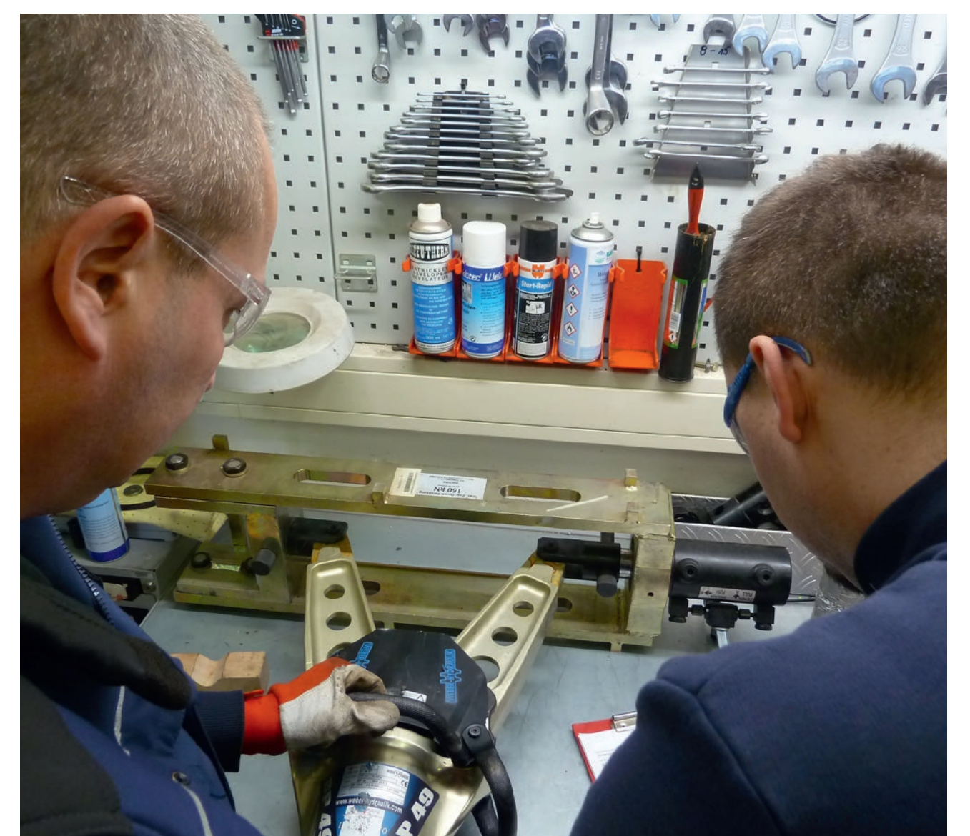
Regelmäßige Prüfung eines hydraulischen Rettungsgerätes, hier: Spreizer bei der Funktions- und Belastungsprüfung
