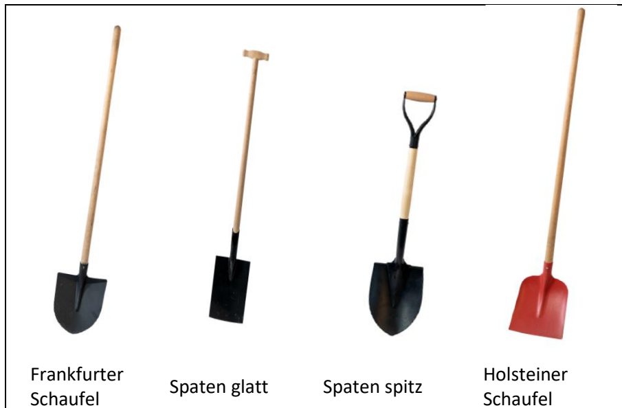
Abbildung 33 Handwerkszeug zur Brandbekämpfung, Teil 1 Bilder: Staatliche Feuerweherschule Würzburg
